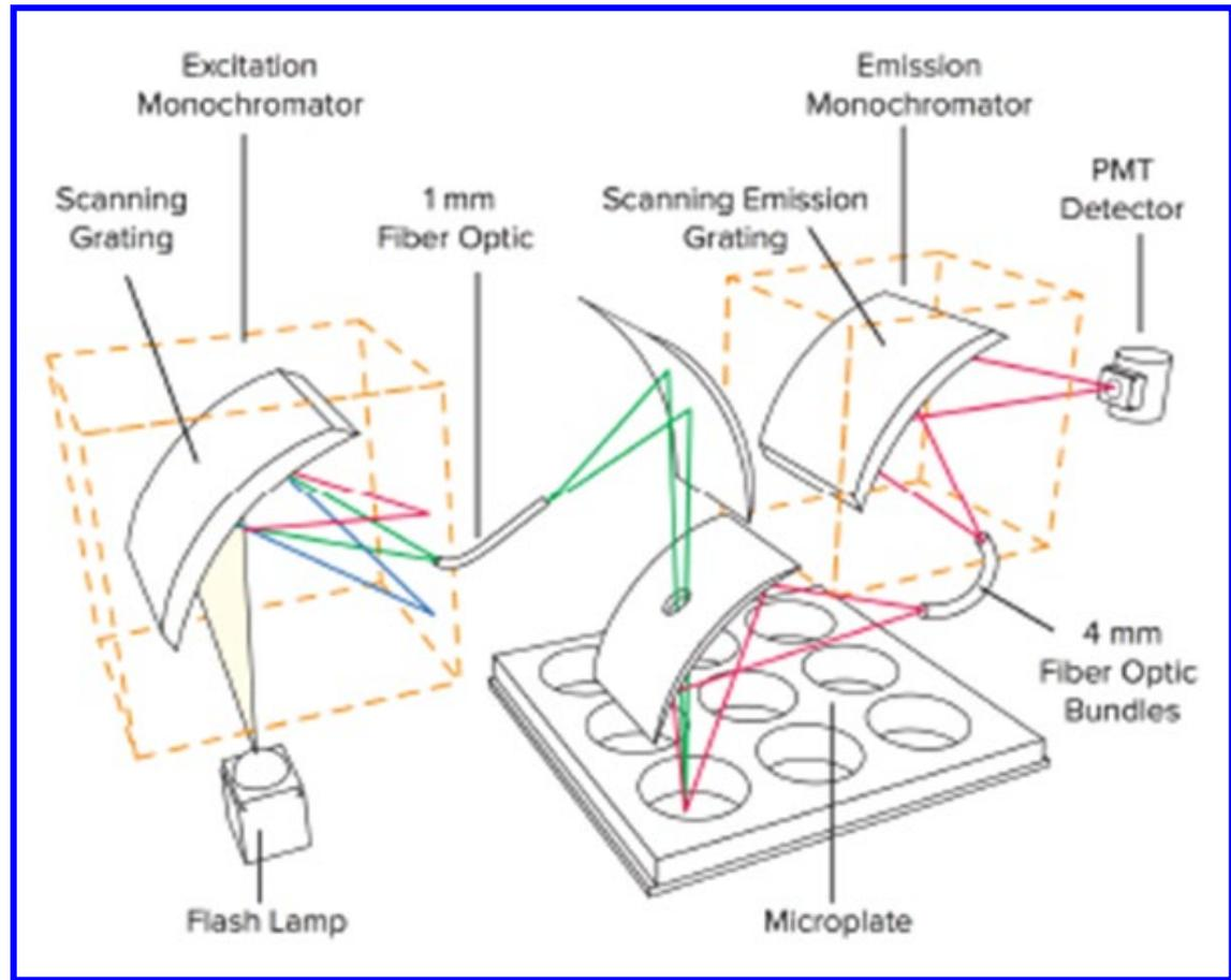
Uno specifico fascio di radiazione di eccitazione viene convogliato da una fibra ottica verso uno specchio e da questo inviato su un particolare pozzetto della micropiastre. La radiazione di fluorescenza (policromatica) emessa dal pozzetto viene raccolta da un'altra fibra ottica e da essa inviata verso un ulteriore monocromatore concavo, per la selezione della radiazione di emissione ad una particolare lunghezza d'onda, successivamente rivelata da un PMT.
