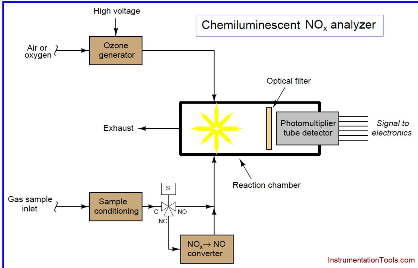
Tipicamente, la camera di reazione è collegata ad una pompa da vuoto, che, oltre ad aspirare la miscela prodotta dal processo (*Exhaust*) e trasferirla ad un dispositivo che decompone l'ozono residuo, mantiene una pressione bassa nella camera, riducendo il quenching della chemiluminescenza dell' $\text{NO}_2^*$ .
