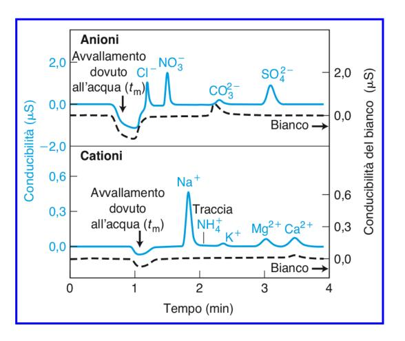
Ne consegue che, se il campione iniettato nella colonna analitica è rappresentato da una soluzione acquosa di ioni di interesse priva dello ione retro-scambiatore la corrispondente banda di acqua eluirà al tempo morto e, avendo una conducibilità elettrica inferiore a quella della fase mobile, determinerà la registrazione di valori apparentemente negativi della conducibilità durante la sua eluizione.
