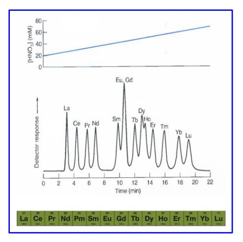
In figura è riportato il cromatogramma ionico relativo ad una miscela di ioni trivalenti dei lantan(o)idi, rivelati spettrofotometricamente per reazione post-colonna con un complessante.
