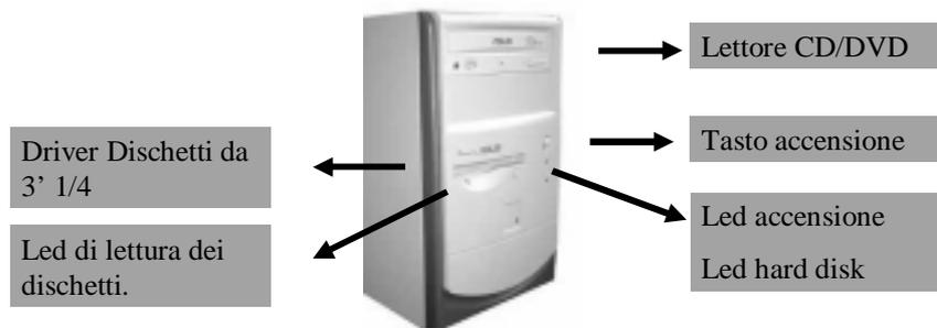
Un dischetto non deve essere espulso fino a che il led del driver è acceso altrimenti si rischia il danneggiamento del disco stesso con una possibile perdita dei dati.
